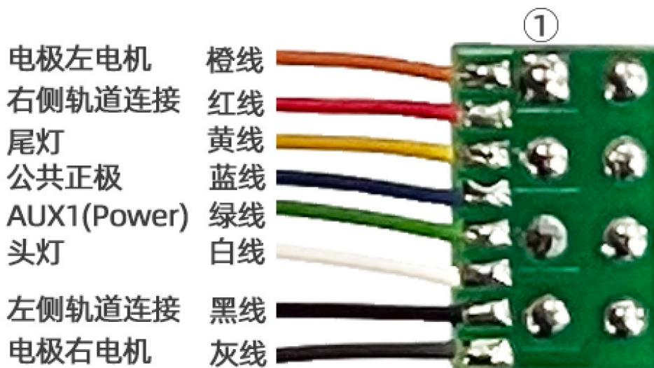
图 1-1 : 5323 8 针芯片插头接线图
